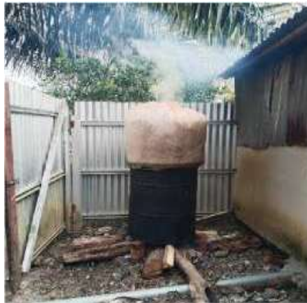
Gambar 6. Sterilisasi baglog dengan sistem autoclave
