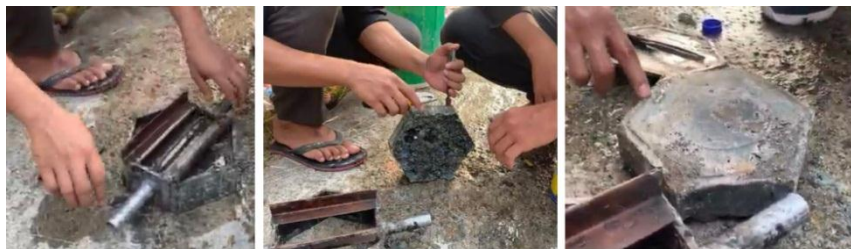
Gambar 2. Hasil akhir paving block dari sampah plastik
