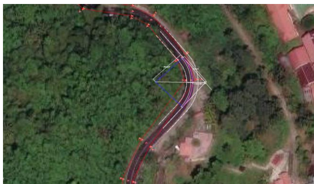
Gambar 3. Perbandingan Alinyemen Horizontal Eksisting dengan Hasil Evaluasi Tikungan 3
