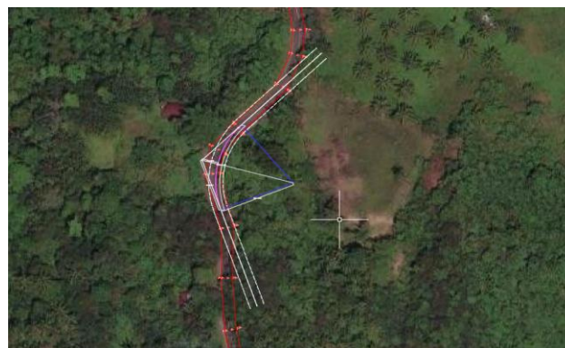
Gambar 2. Perbandingan Alinyemen Horizontal Eksisting dengan Hasil Evaluasi Tikungan 2
