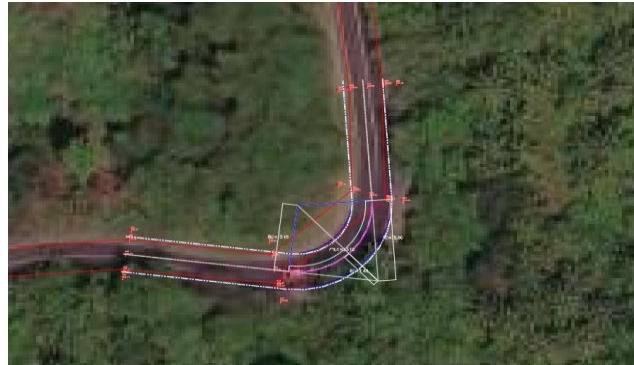
Gambar 1. Perbandingan Alinyemen Horizontal Eksisting dengan Hasil Evaluasi Tikungan 1
