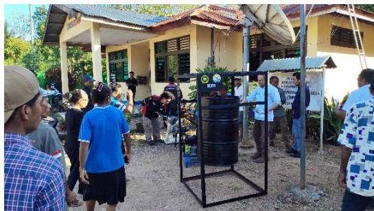
Gambar 2a. Drum pirolisis untuk karbonisasi cangkang kemiri
