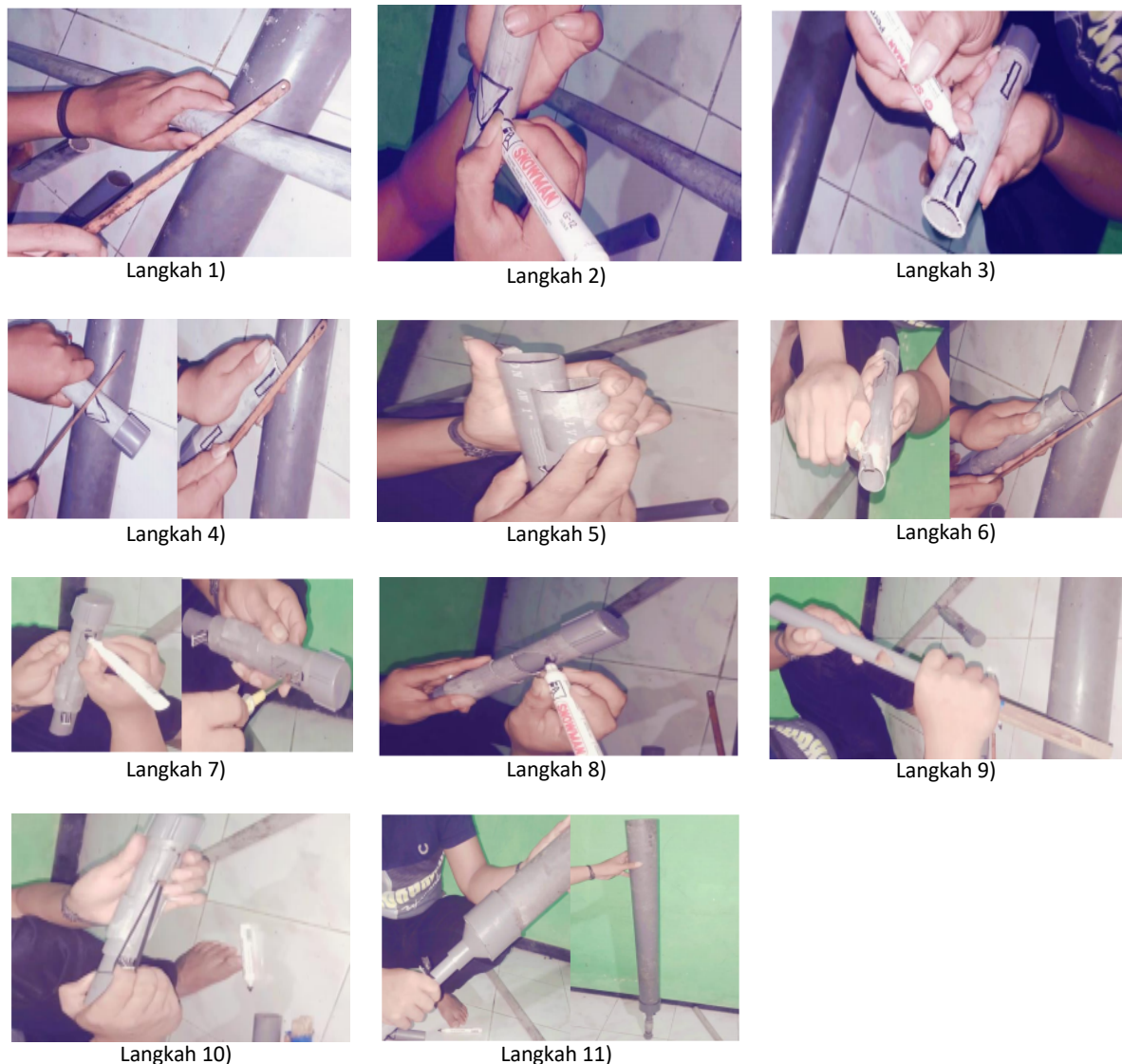
Gambar 3. Langkah-langkah pembuatan alat pemupukan jagung semi otomatis dengan 11 langkah.
