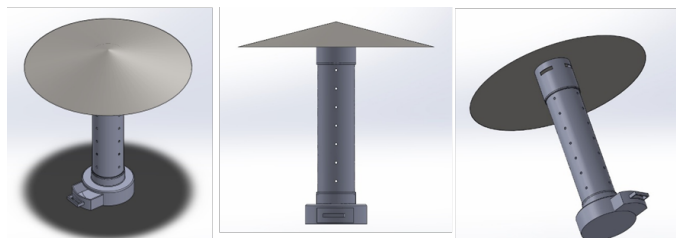
Gambar 1. Desain alat pemanas anak ayam "citer (chick heater)"
