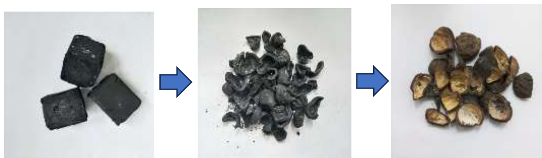
Gambar 6. Bahan baku cangkang kemiri, hasil pengarangan dan briket dari cangkang kemiri
